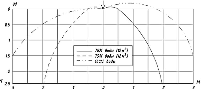
**Графики зависимости интенсивности от давления для оросителей водяных и пенных для высоты 2,5 м и площади 12 м<sup>2</sup>**
