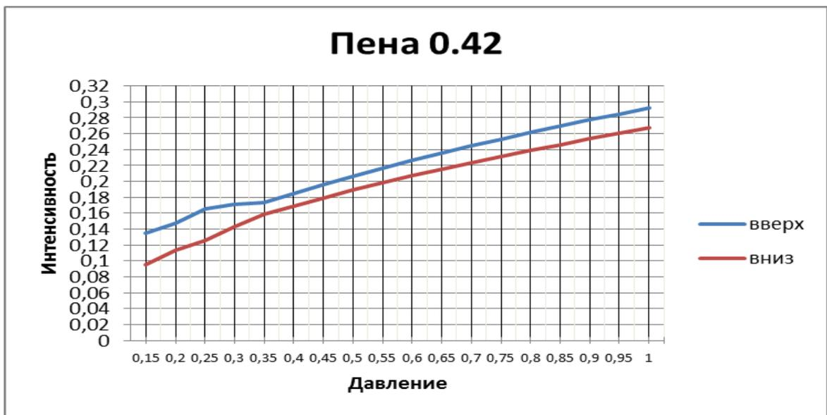
**График зависимости интенсивности орошения от давления на площади 12 м<sup>2</sup>, защищаемой группой оросителей (два и более) с высоты 2,5 м**
